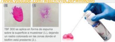
TBF 300 se aplica en forma de espuma sobre la superficie a muestrear (1.), dejando un rastro coloreado en las zonas donde el biofilm está presente (2.).
