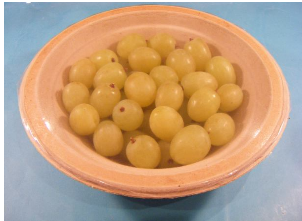
Envasado de uvas en envase biodegradable de celulosa proveniente de residuos agrícolas con film cubierta de PLA
