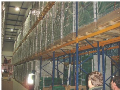
Figura 3 – Conservación de bayas en atmósfera controlada individualizada por palet (foto Van Amerongen).
